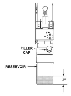
HYDRAULIC FLUID LEVEL (LH PUMP SHOWN) FIG. 40-1
